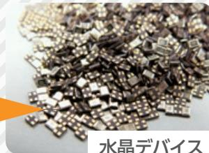
電極を付した数ミリの水晶片を、電子ビームを利用しパッケージの中に真空状態で封入します。
