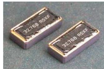
音叉型水晶振動子は、電子機器内部で正確な時を刻む時計機能の基となるものです。TFX-02は当社従来品と比べて22%の小型化を達成し、3.2×1.5×0.8ミリと、業界最小クラス※を実現しました。携帯電話やデジタルカメラなど、ほとんどの電子機器に時計機能が内蔵されています。既に量産を開始したTFX-02は、小型化が進む電子機器において様々な分野での採用が期待されます。
